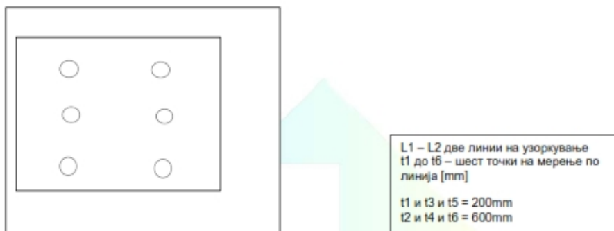
Слика бр. 7: Приказ на линии и точки на мерење на испуст од пакување 2 A10
